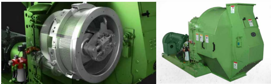
Figuur 10: Voorbeeld van een pelletpers. Afval wordt bovenaan via een transportschroef toegevoegd en komt vanaf de zijkant in de matrijs. Afval wordt naar buiten door de roterende matrijs geperst. De geperste korrels verlaten de pers van onderaf.
