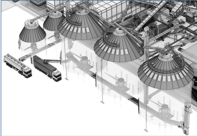
Figuur 12: Voorbeeld van een pelletsilo-opslag inclusief laadsilo's om vrachtauto's van bovenaf te vullen.
