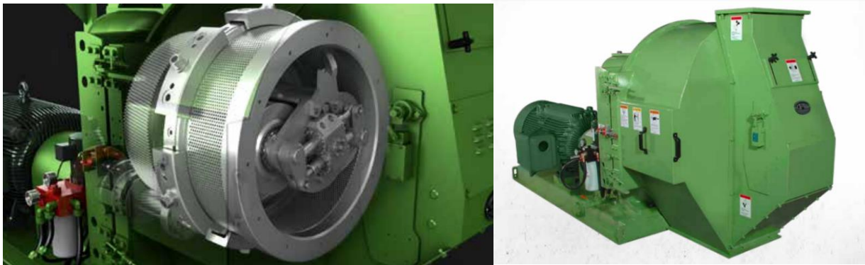
Figuur 10: Voorbeeld van een pelletpers. Afval wordt bovenaan via een transportschroef toegevoegd en komt vanaf de zijkant in de matrijs. Afval wordt naar buiten door de roterende matrijs geperst. De geperste korrels verlaten de pers van onderaf.
