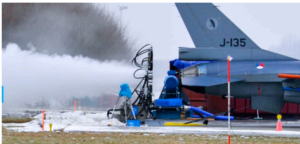
Figuur 9: Proefopstelling voor waterinjectie op de jetblast van een F-16 die aan het proefdraaien is (Bos, 2010)
