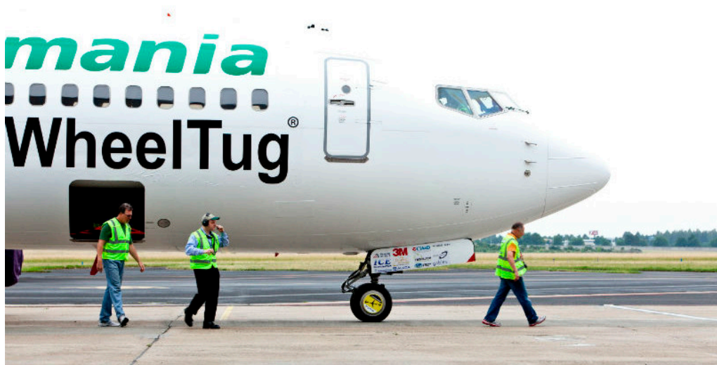
Figuur 11: WheelTug, een systeem met elektromotor dat in het neuswiel is geïntegreerd. (Bron afbeelding: deingenieur.nl)
