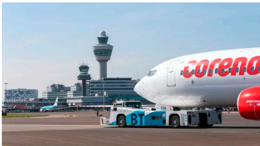
Figuur 10: TaxiBot wordt momenteel operationeel getest op Schiphol. (Bron afbeelding: Schiphol)
