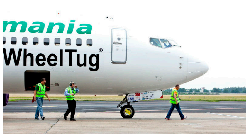
Figuur 19: WheelTug, een systeem met elektromotor dat in het neuswiel is geïntegreerd. (Bron afbeelding: deingenieur.nl)
