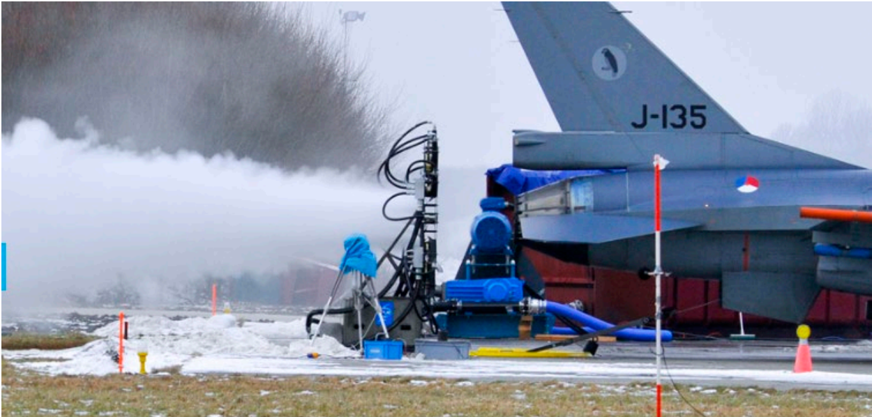
Figuur 17: Proefopstelling voor waterinjectie op de jetblast van een F-16 die aan het proefdraaien is (NLR, 2010)
