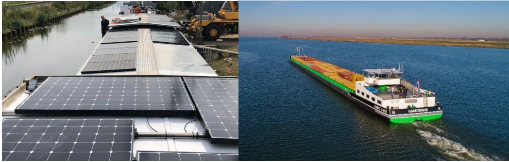
Figuur 10 Vrachtschip "The Traveler" 23 op zonnepanelen (links) en "Sendo liner" met een batterijpakket (rechts).
