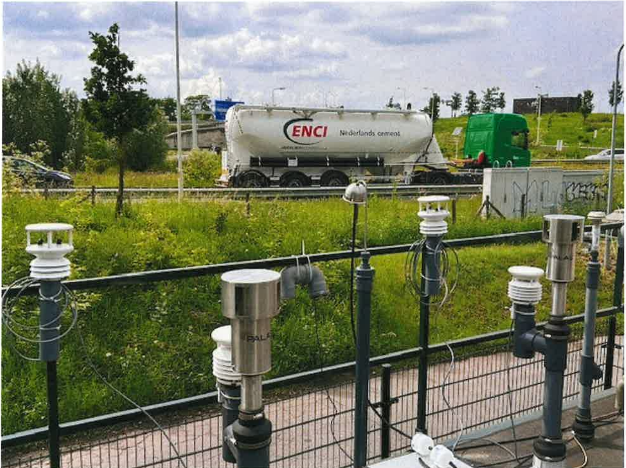
De aanzuigbuizen op het dak van het meetstation Philipsweg voor Fijnstof, UFP en Roet
